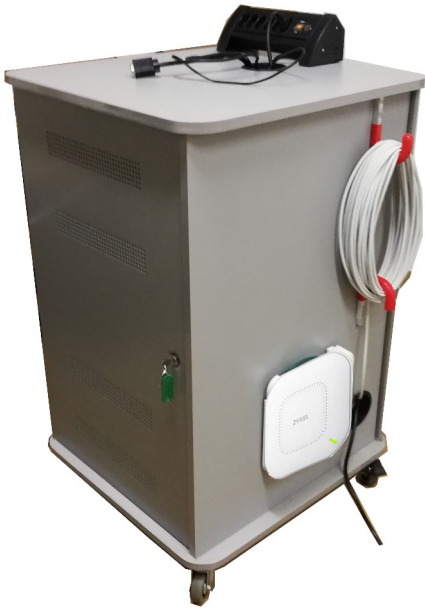
Vue avant armoire multimédia et borne WIFI
